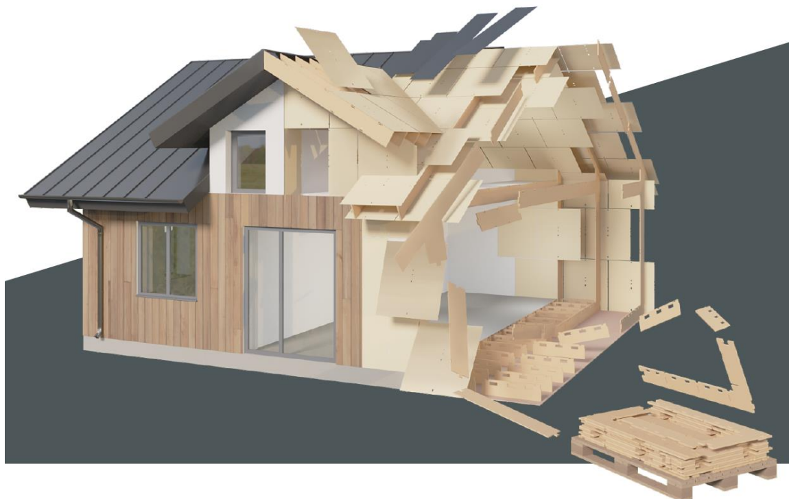
Рис. 2. Малоэтажное здание с мансардным этажом, запроектированное полностью из фанерных несущих и ограждающих элементов без применения клеевых соединений
