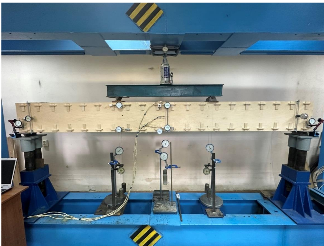
Рис. 3. Общий вид экспериментальной фанерной балки, подготовленной к испытаниям Fig. 3. General view of the experimental plywood beam prepared for testing
